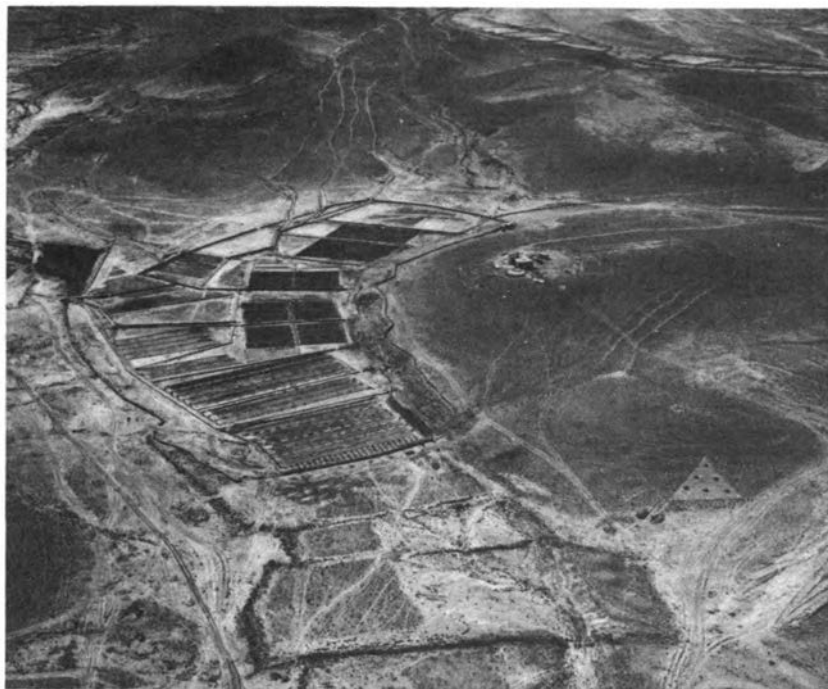
FIGURE 15 Ancienne ferme reconstruite à Avad dans le Néguev. La ferme est (et était) arrosée par le ruissellement des eaux venant des versants et des ouadi environnants. A l'avant-plan apparaissent quatre terrasses reconstruites; à l'arrière-plan quatre canaux reconstruits acheminent le ruissellement jusqu'à la ferme. A droite on peut distinguer les traces de trois canaux qui autrefois acheminaient l'eau de ruissellement vers les terrasses inférieures. Le rapport entre le bassin et la superficie cultivée est de 20:1—chaque hectare de terre cultivée reçoit un écoulement de 20 ha de versant ainsi que des précipitations directes. La superficie cultivée reçoit un volume d'eau grosso-modo égale à des précipitations de 300-500 mm de précipitations effectives. (L. Evenari)
