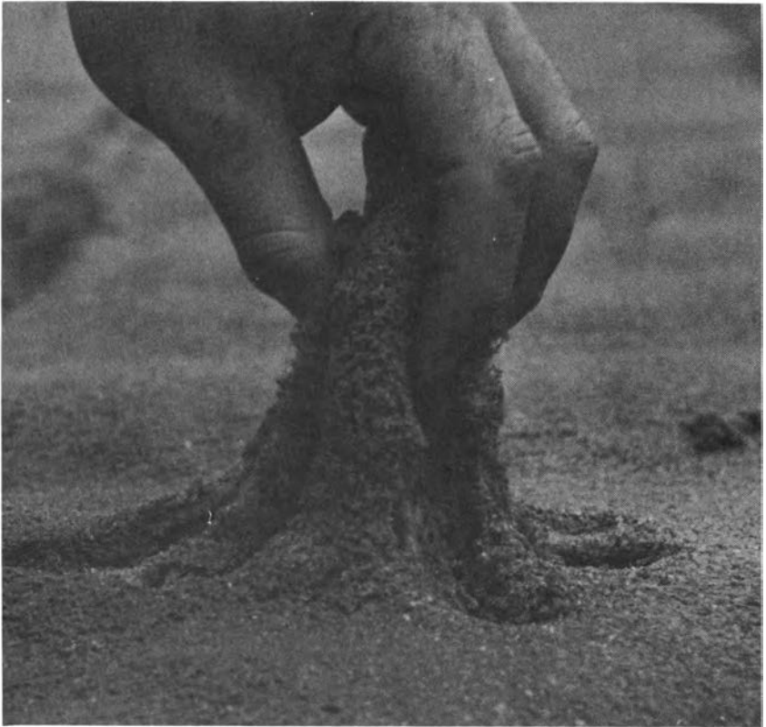
FIGURE 54 Consistance du sable stabilisé avec une couverture d'huile/latex. Une surface hermétique réduit les pertes d'évaporation et maintient le sable en place suffisamment longtemps pour que les plants s'accrochent bien. (International Synthetic Rubber Company, Ltd.)
