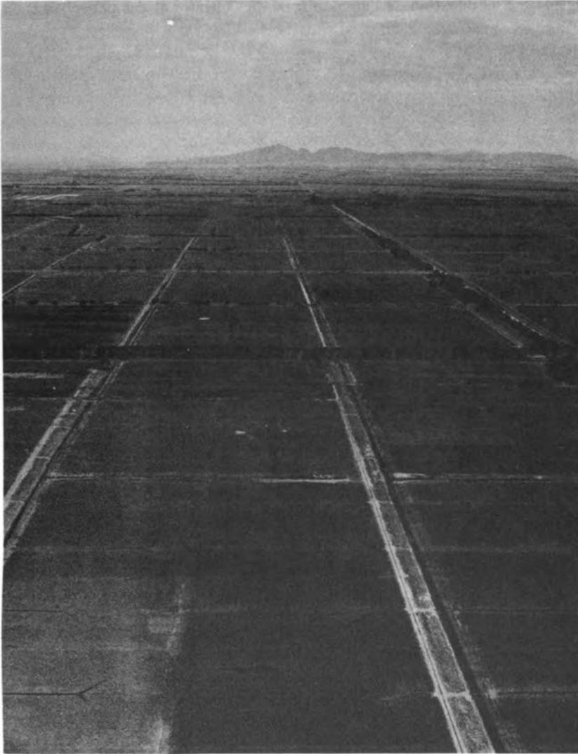
FIGURE 31 Cette exploitation agricole du Conseil des Travaux Publics de la ville de Melbourne et de la zone métropolitaine à Werribee (Australie) utilise depuis longtemps des eaux usées traitées de la ville de Melbourne comme eaux d'irrigation. Autrefois désertique, aride et balayée par les vents, cette plaine est aujourd'hui la principale installation d'évacuation des eaux usées qui dessert plus de 1,5 million d'habitants (le volume des eaux usées est de 360 millions de litres par jour en moyenne et de 950 mld pendant les périodes de pluie). L'exploitation alimente 15.000 bovins par an; de 40.000 à 40.000 ovins sont engraisés pendant le printemps et l'été, ce qui se solde par la vente de 5.000 bovins, 36.000 ovins et 250 balles de laine une année moyenne. (Conseil des Travaux Publics de la ville de Melbourne et de la zone métropolitaine).
