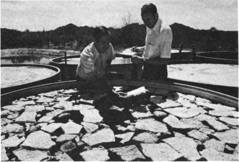
FIGURE 41 Expérience dans l'Arizona (Etats-Unis) où la cire est utilisée pour supprimer l'évaporation. Des blocs de cire ont été ajoutés à la citerne du premier plan. La chaleur du soleil fait fondre la cire et la transforme en une pellicule continue que l'on peut voir sur les citernes à l'arrière-plan. Pendant quatre ans, cette pellicule a supprimé plus de 85 pour cent de l'évaporation normale. (K. C. Cooley).
