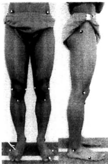
图 10-8-4 步态分析仪器的标记系统 左:正面视图;右:侧面视图
