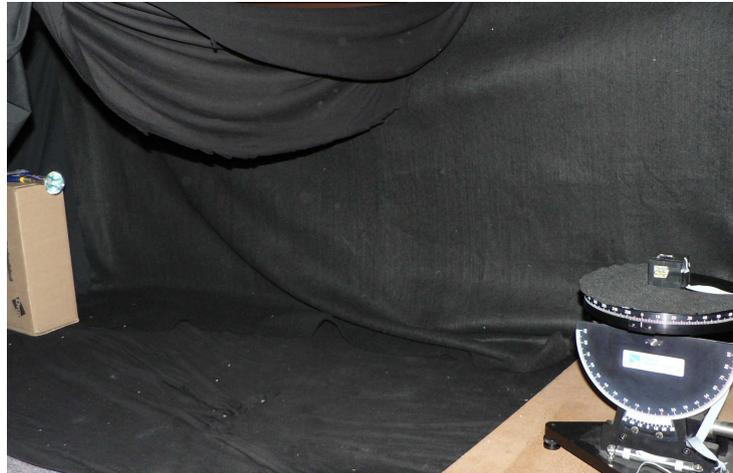
(b) Actual Coarse sun sensor test setup
