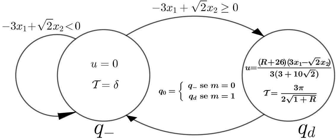
Figure 3.6: O hybrid control  $\mathcal{H}(\Omega, R, \delta, m)$  para  $\Omega$  definido em (3.27).
