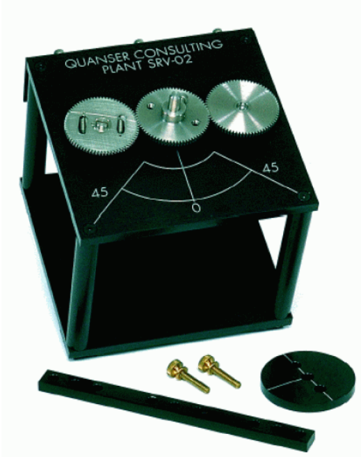
Fig. 33. Quanser SRV-02 DC motor system.
